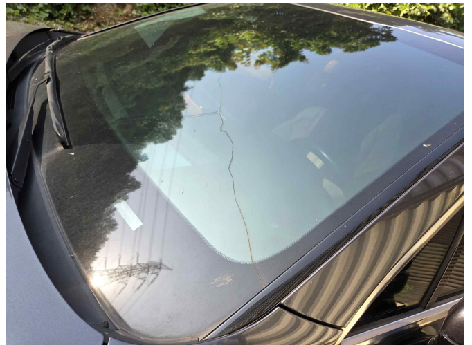
전면유리 손상 부분(금이 간 상태) 전경
