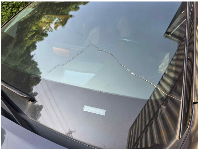
전면유리 손상 부분(금이 간 상태) 전경
