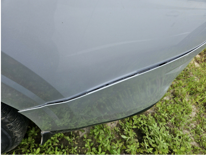
본건 후면 범퍼 들뜸 상태
